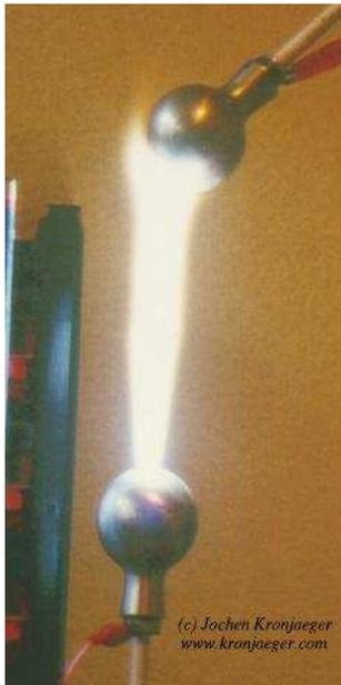
Lorsque le transfert d'énergie vers le gaz est suffisant, celui se transforme en **plasma** : mélange de molécules et d'atomes neutres, de ions atomiques et moléculaires, d'électrons, le tout étant globalement électriquement neutre.
