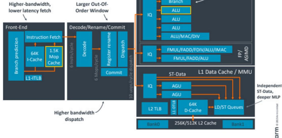
Arm Cortex-A77: 2 unités ASIMD(128-bit), jusqu'à 2 SP FMAs/cycle (SP FMA: Single precision Fused Multiply-Add)
